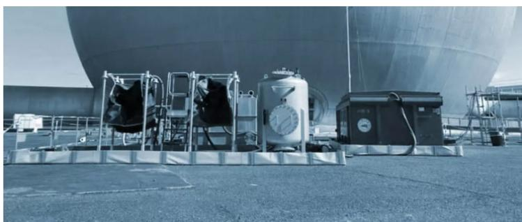
En raison d'une filière d'élimination très coûteuse, le rejet était impossible. Il fallait donc traiter en ligne et minimiser le volume des  $250 \text{ m}^3$  d'effluents issus du décapage, chauds et très chargés :
